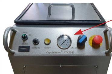
Régulateur de pression en série, panneau de contrôle intuitif, horomètre, poignées avant, protection thermique (moteur)...
